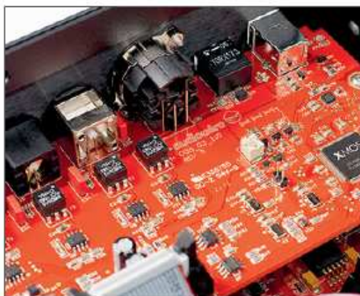
Tradycyjne wejścia cyfrowe obsługuje scalak CS8414, zaś wejście USB – procesor firmy XMOS
